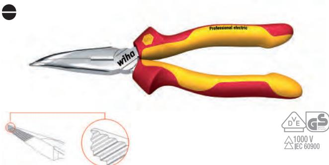
**Уменьшает расходы:** Долговечные благодаря высококачественному хромированию поверхностей, что препятствует повреждению ржавчиной. **Повышает эффективность:** Сверхдлинная головка клещей для введения расположенных глубоко деталей. **Предоставляет полную защиту:** Каждый инструмент отдельно протестирован при напряжении 10000 В переменного тока и имеет разрешение к применению при напряжении 1000 В переменного тока.
