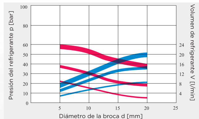
Fig. 1: Presion y volúmen de refrigerante necesario para brocas con canales de refrigeración interior en espiral.
